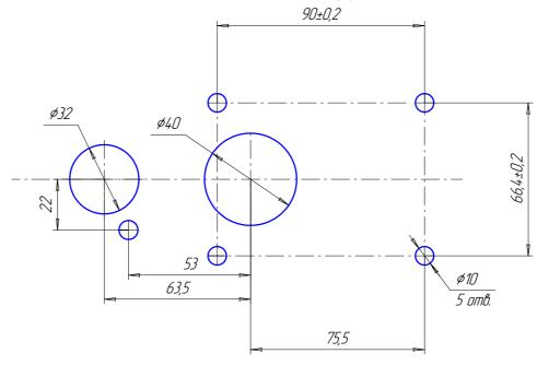
Рис. 6 – Монтажные отверстия для установки нагревателя
