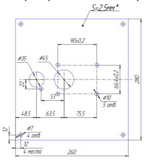
Рис 7- Пластина монтажная
