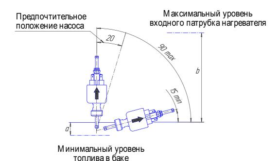
а – высота всасывания до 700 мм; b – высота напора между топливным насосом и нагревателем, до 1500 мм.
