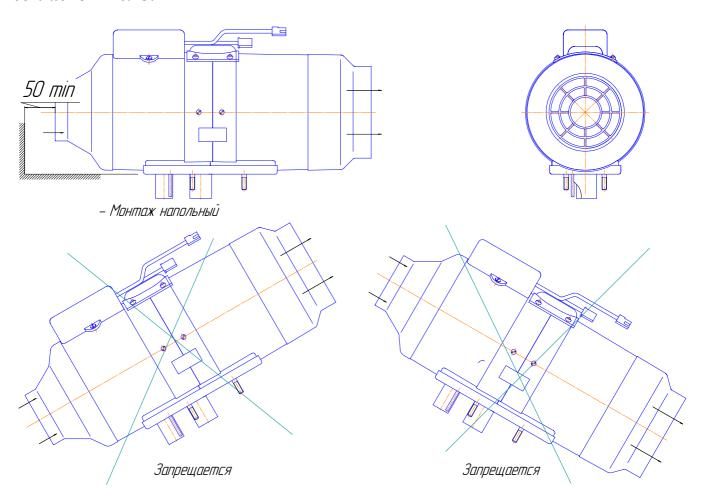
Рис. 5 – Установка нагревателя
