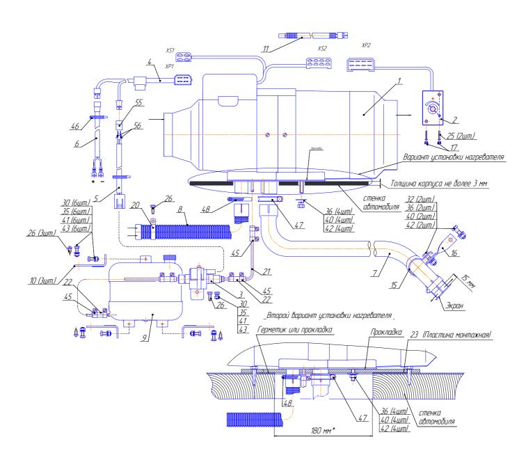
Рис 4 – Схема соединений основных узлов и деталей отопителя
