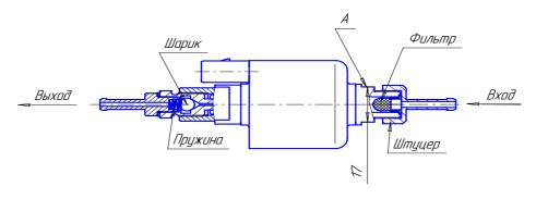
Рис. 12 - Топливный насос
