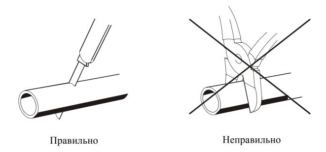
Рис. 11 – Отрезка трубопровода перед установкой.
